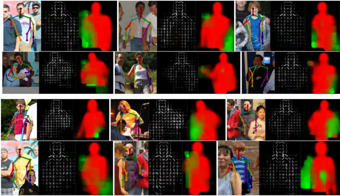
图 8, H3D 数据集中的姿态样本以及遮挡估计图。每张图显示了关键点的位置 (虚线表示遮挡), 变形的 HOG 模版的可视化以及通过组合单个部分混合模式得到的遮挡物—人体—背景分割图。这 18 张图都代表了 32 中混合 (遮挡) 状态产生的 3218 中可能的遮挡模式之一。前两行显示了来自 H3D 数据集的样本, 后两行来自 H3D 经综合分析得到的数据。
